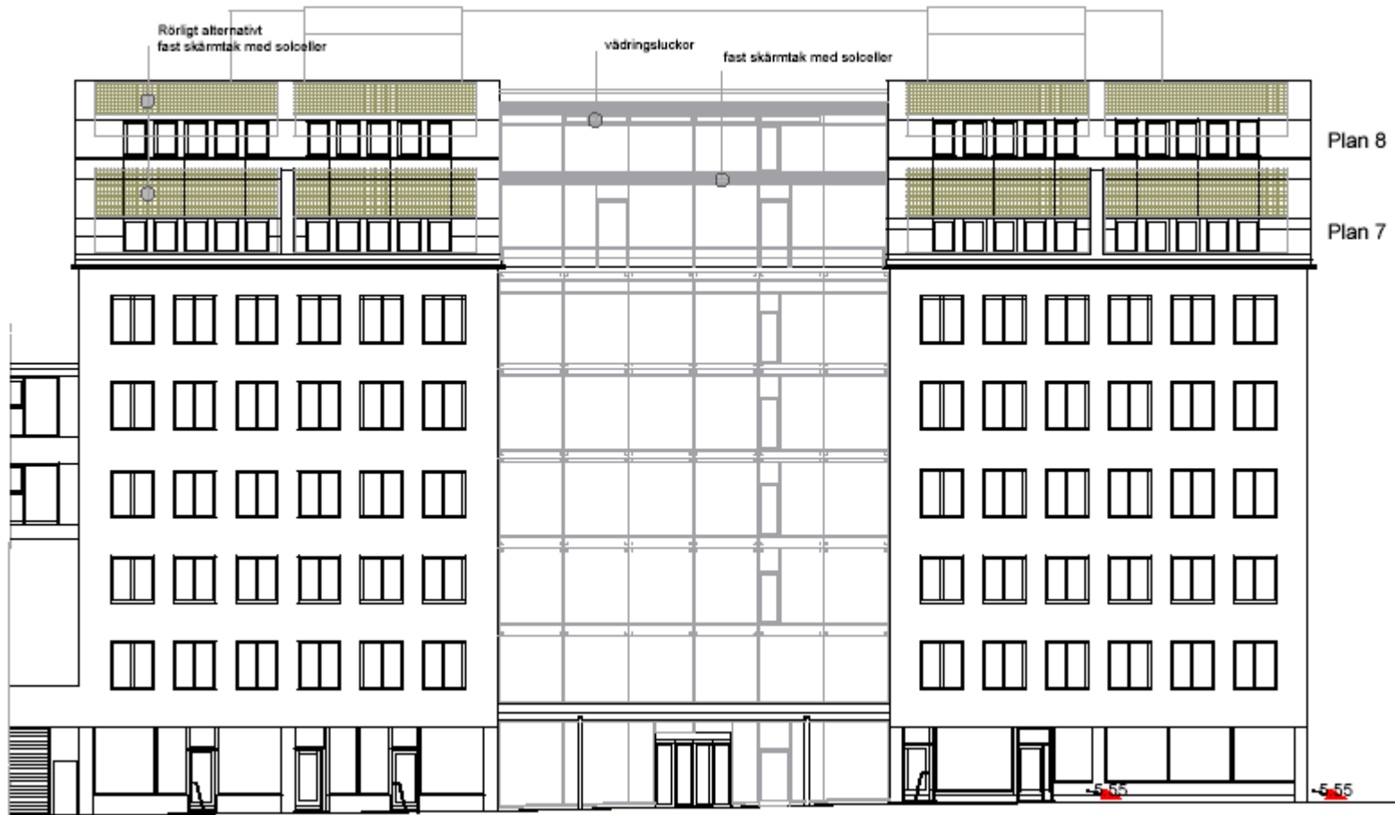
Fasad mot Lindhagensgatan Kv Lyckan 10 Förslag på skärmtak och solavskärmning med solceller för plan 7 och 8. GWSK Arkitekter 050315
